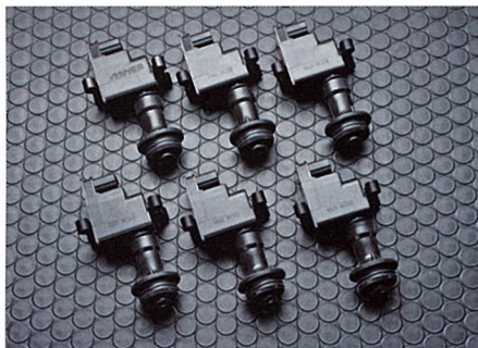
BNR34用。二次コイルの巻数を増やしており、かつR35など最近のクルマでは広く使われている磁石を内蔵する。イグニッションコイル自体は第2世代すべてにボルトオン
